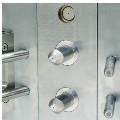
▲ Il punzone per il corpo ha un raffreddamento ravvicinato, realizzato con la tecnologia LaserCUSING®
