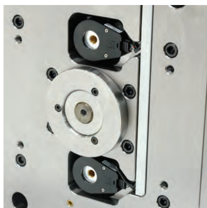
▲ Il fondello è iniettato ad otturazione. Attuatori elettrici passo-passo con encoder monitorano la posizione dell'otturatore
