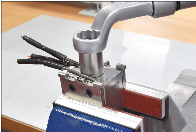
Abbildung 88: Düse einspannen und Adapter lösen
