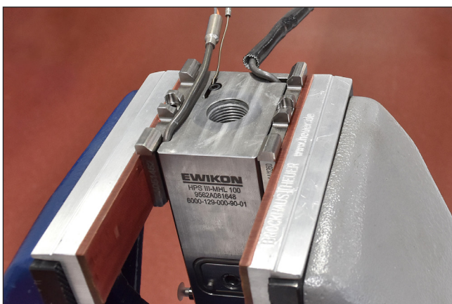
Abbildung 99: Thermofühler in die Bohrung stecken und fixieren
