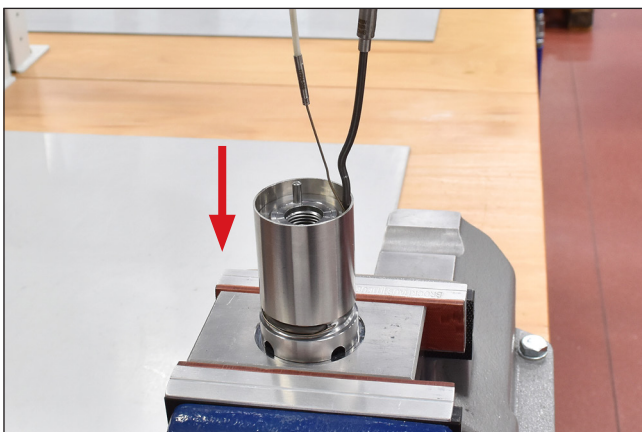
Abbildung 112: Thermofühler verlegen, Schutzrohr nachschieben
