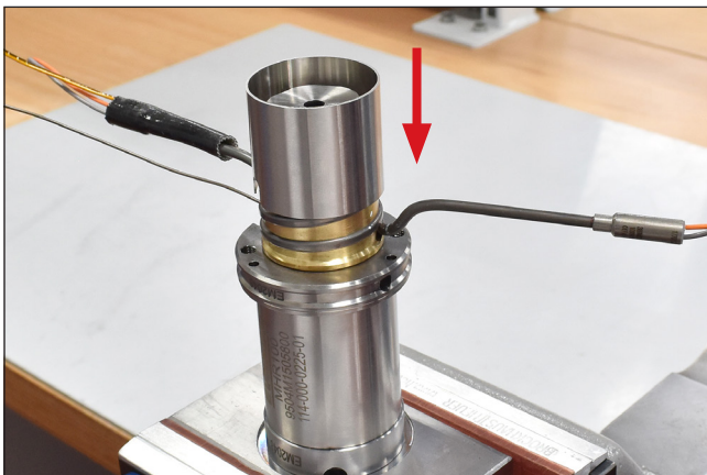
Abbildung 106: Thermofühler biegen, Schutzrohr nachschieben
